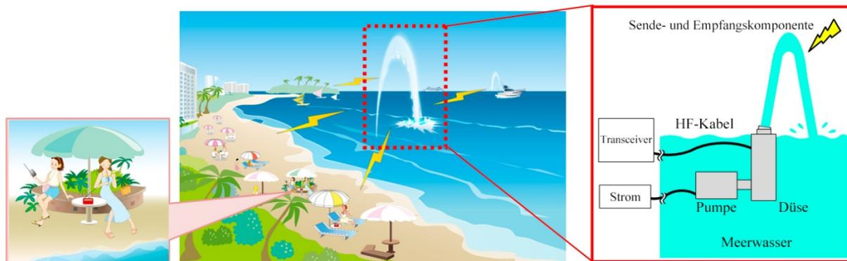
Eine Meerwasserfontäne kann als Antenne genutzt werden, wenn sie entsprechend isoliert wird. Daher hat Mitsubishi Electric nun eine isolierte Düse entwickelt, die selbst dann Radiowellen an die Antenne überträgt, wenn die Fontäne physisch mit der Meeresoberfläche verbunden ist. Eine effektive Isolierung wird durch eine Viertelwellenlängen-Röhre in der Düse erreicht.
