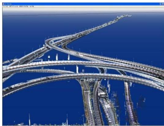
Beispiel 2: Ausmessen einer 3D-Kreuzung mit Standard-Laserscannerbildern und einkopierten Farbkamerabildern
