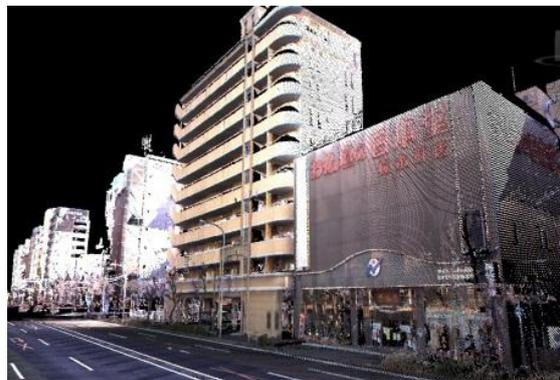
Beispiel 4: Detaillierte Ausmessung des Gebäudeerscheinungsbilds mit optionalem Langstrecken- oder High Density-Laserscanner
