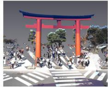
3D-Punktwolke aus mit MMS gesammelten Daten
