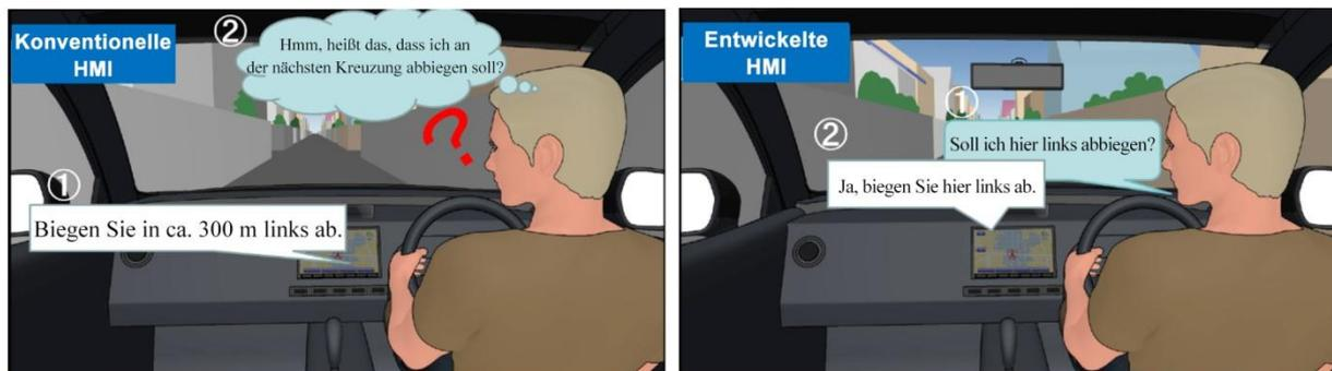
Vergleich zwischen einem konventionellen Navigationssystem und der neu entwickelten HMI „natürliche Navigation“
