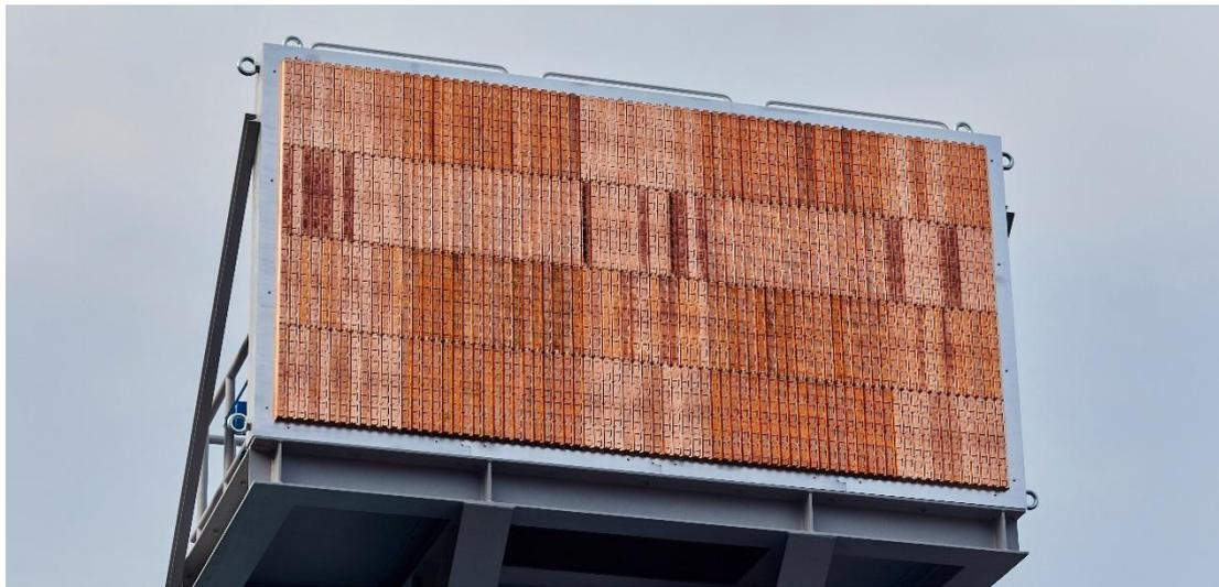
Prototyp der Harzspritzguss-Antenne mit Hohlleiter-Array
