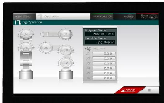
Módulo TFT-LCD a color con panel táctil capacitivo proyectado
