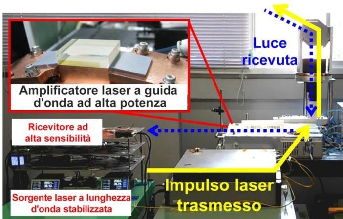
Dimostrazione dei metodi di misurazione della concentrazione di vapore acqueo DIAL e della velocità del vento LIDAR
