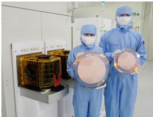
Wafer in silicio da 12 pollici e apparecchiatura di misurazione della resistenza, mostrati, come riferimento, insieme a un wafer da 8 pollici (a destra)
