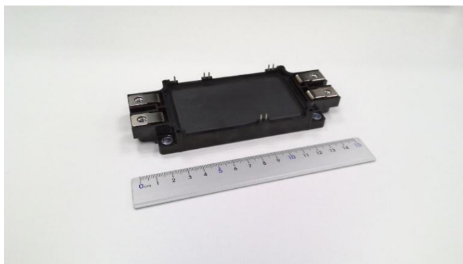
Modulo IGBT tipo NX da 1,2 kV per uso industriale (modello CM1000DX-24M)
